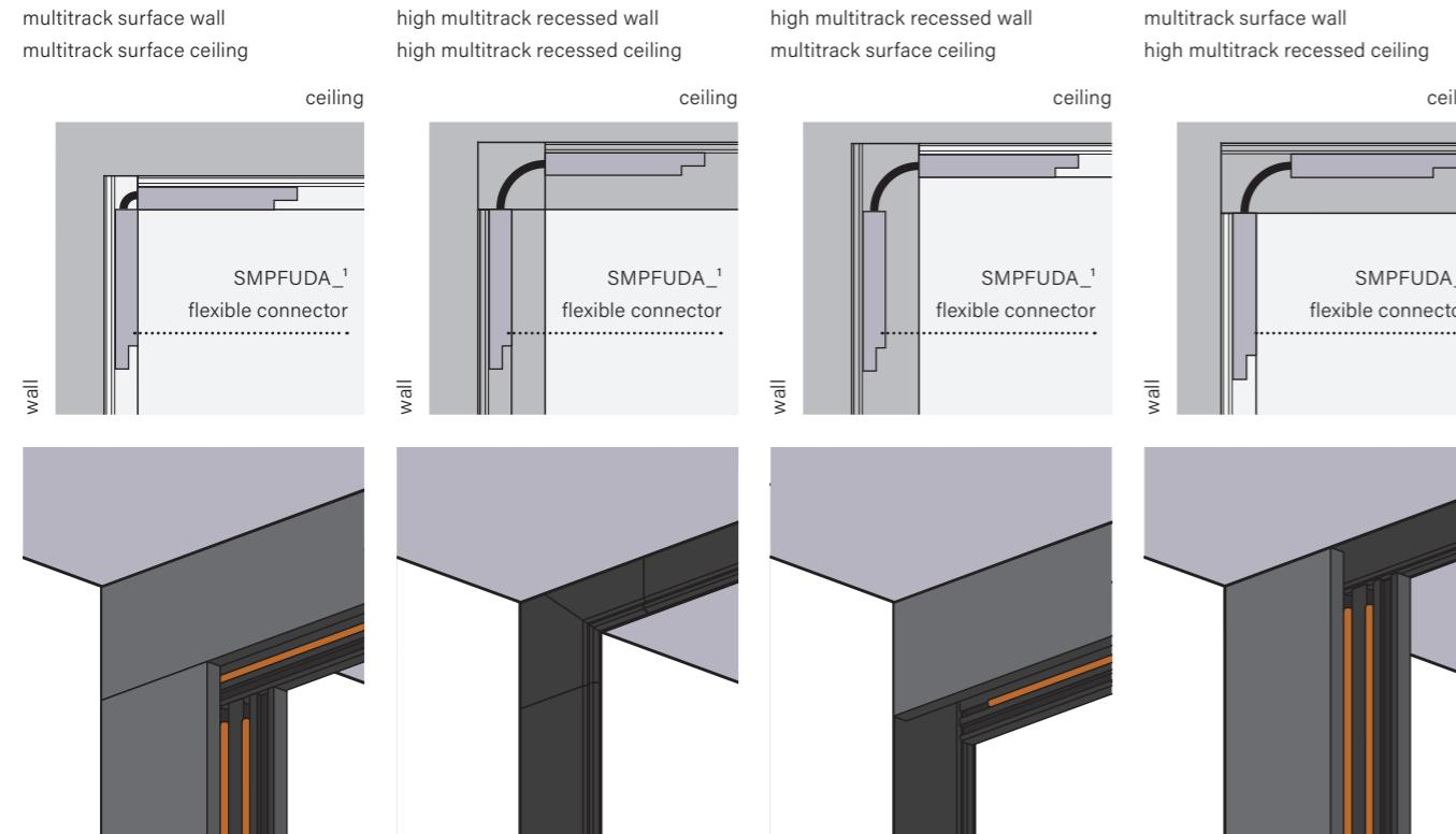
**Possibilities of connecting profiles with different types of power supplies / Możliwości łączenia profili z różnymi typami zasilaczy**
