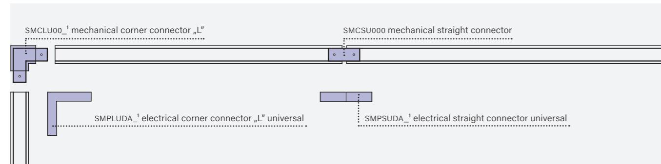
**Examples of connecting ceiling-wall transitions / Przykłady połączenia ściany-sufit**
