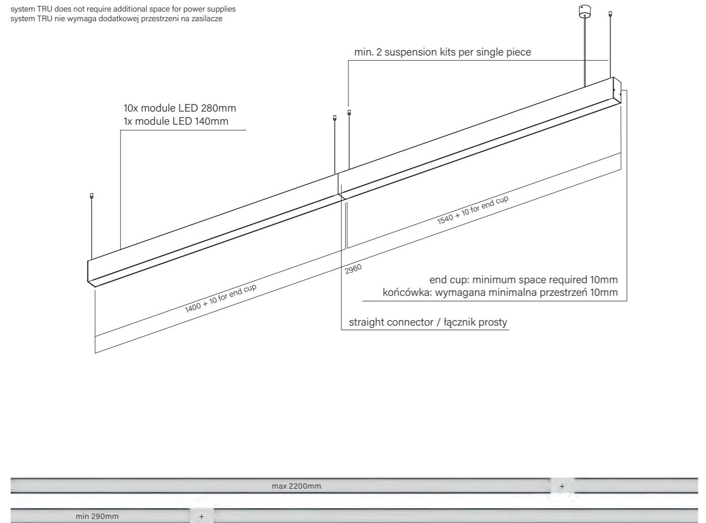
The minimum length of a connectable segment is 290mm / Minimalna długość jednego odcinka to 290mm
