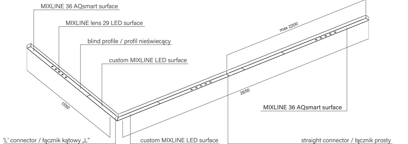
For one power supply section, the minimum lighting segment length is 290mm. / Na jedną sekcję zasilającą minimalna długość odcinka świecącego to 290mm. The maximum length of a single section is 2200mm (including power supply section). / Maksymalna długość pojedynczego odcinka oprawy wynosi 2200mm (w tym sekcja zasilająca). For a system longer than 2200mm, it is required to add more than one power supply section. / Dla systemu dłuższego niż 2200mm wymagana jest więcej niż jedna sekcja zasilająca.
