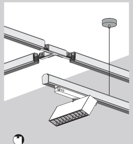
**3F i 3F DALI** – montaż natynkowy (sufit), zwieszany (sufit) i wpuszczany (sufit)
