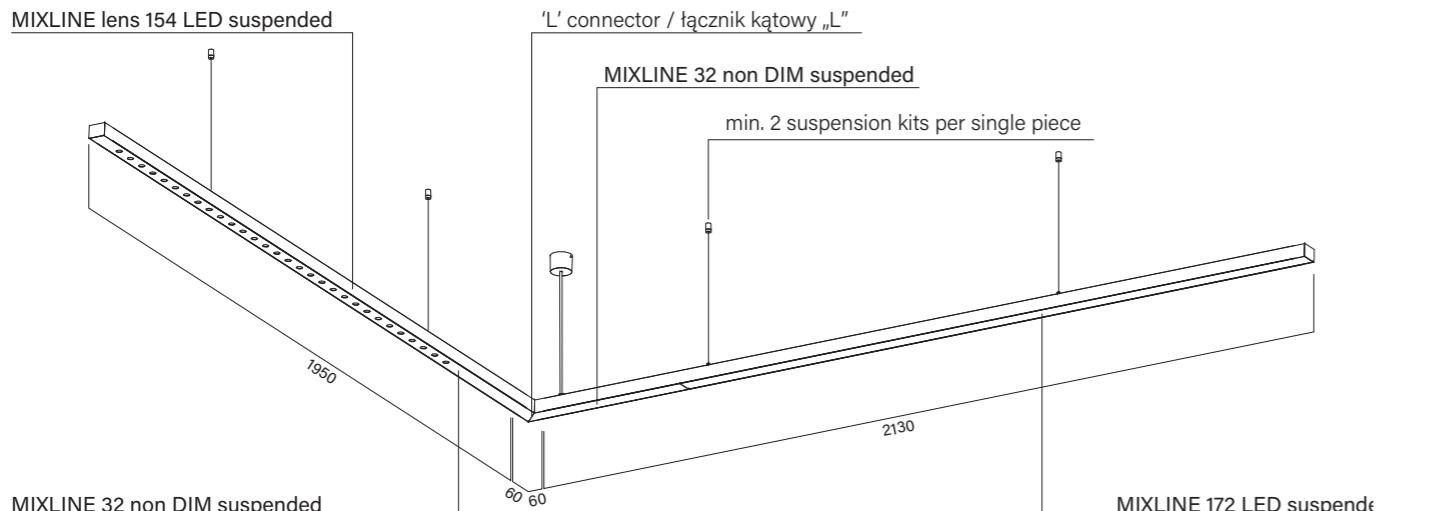
For one power supply section, the minimum lighting segment length is 290mm. / Na jedną sekcję zasilającą minimalna długość odcinka świecącego to 290mm.
