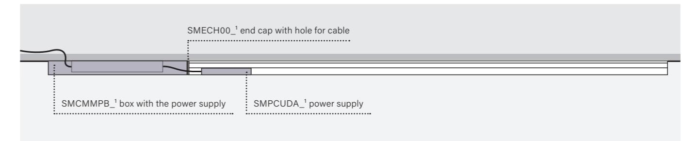
surface multitrack + recessed power supply / szynoprzewód multitrack natynkowy + zasilacz wpuszczany
