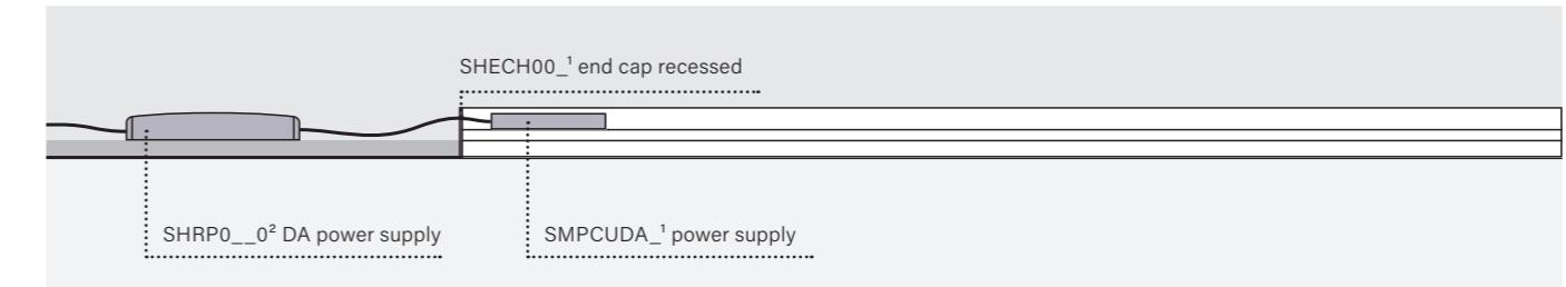
surface multitrack + surface power supply / szynoprzewód multitrack natynkowy + zasilacz natynkowy
