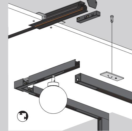
**MULTITRACK** – montaż wpuszczany oraz natynkowy (sufit i ściana) i zwieszany (sufit)
